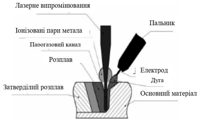
Рисунок 1 – Схема лазерно-дугового зварювання
