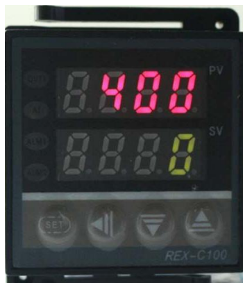
Рисунок 3 - Передня панель ПІД контролеру типу REX C100
