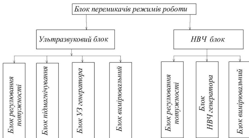
Рис.1 - Схема структурна електротехнологічного комплексу
