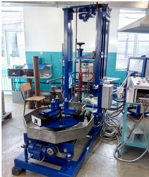
Рисунок 1 – Автоматизована індукційна установка для гарту валів та шестерень.
