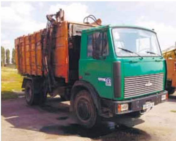
Рис. 21. Сміттєвоз КО-426 із боковим завантаженням на базі шасі МАЗ 533702-240 (головні технічні характеристики: маса завантажених відходів 5,95 тони, місткість кузова 17\text{ м}^3 , коефіцієнт ущільнення до 4, вантажопідйомність маніпулятора 500 кг, потужність двигуна 180 к. с., пальне дизельне)
