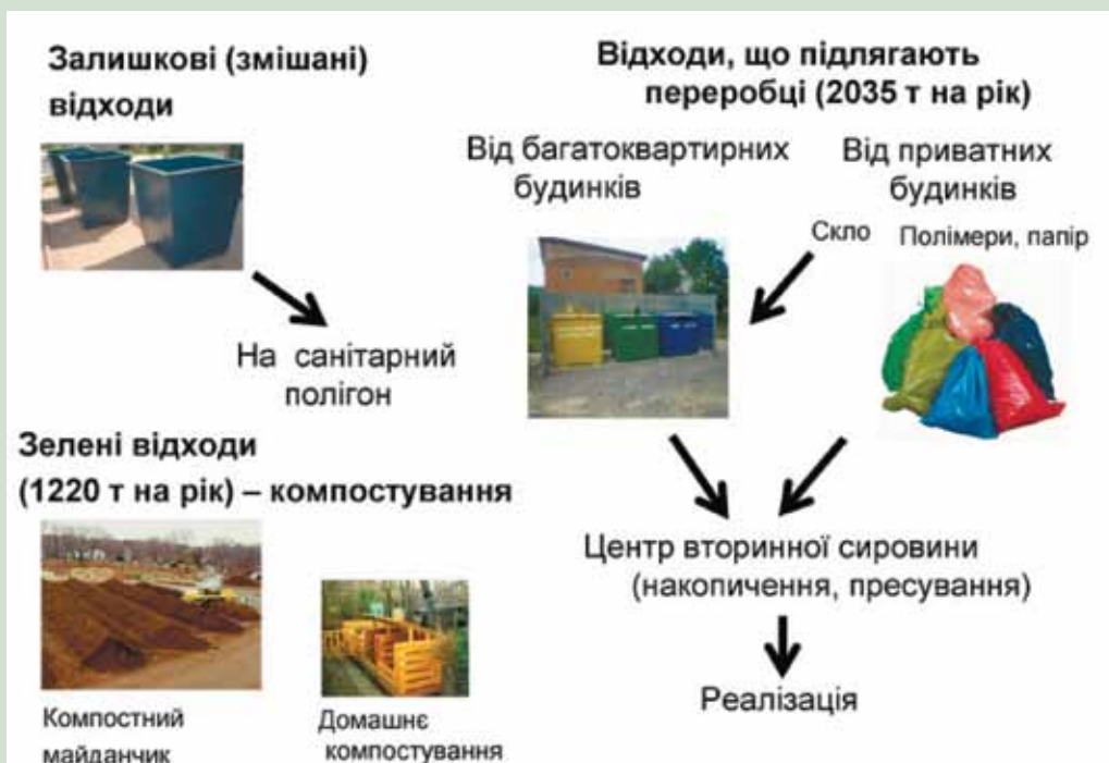
Рис. 26. Схема технічного компонента поводження з відходами в Тульчинському цільовому регіоні
