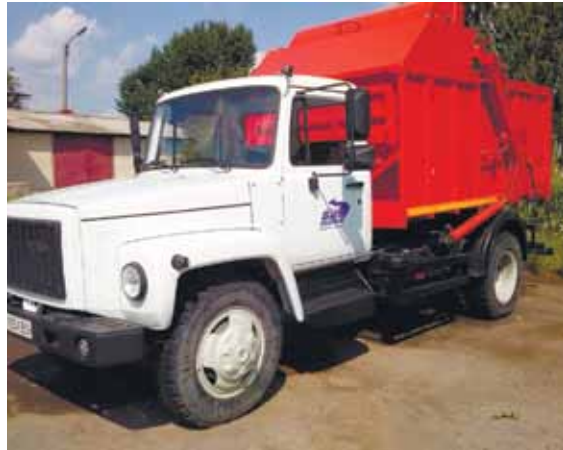
Рис. 22. Сміттєвоз КО-440-1 із заднім завантаженням на базі шасі ГАЗ-3309 (головні технічні характеристики: маса завантажених відходів 3,05 тони, місткість кузова 7,5\text{ м}^3 , коефіцієнт ущільнення від 1 до 4, вантажопідйомність маніпулятора 500 кг, потужність двигуна 125 к. с., пальне дизельне)
