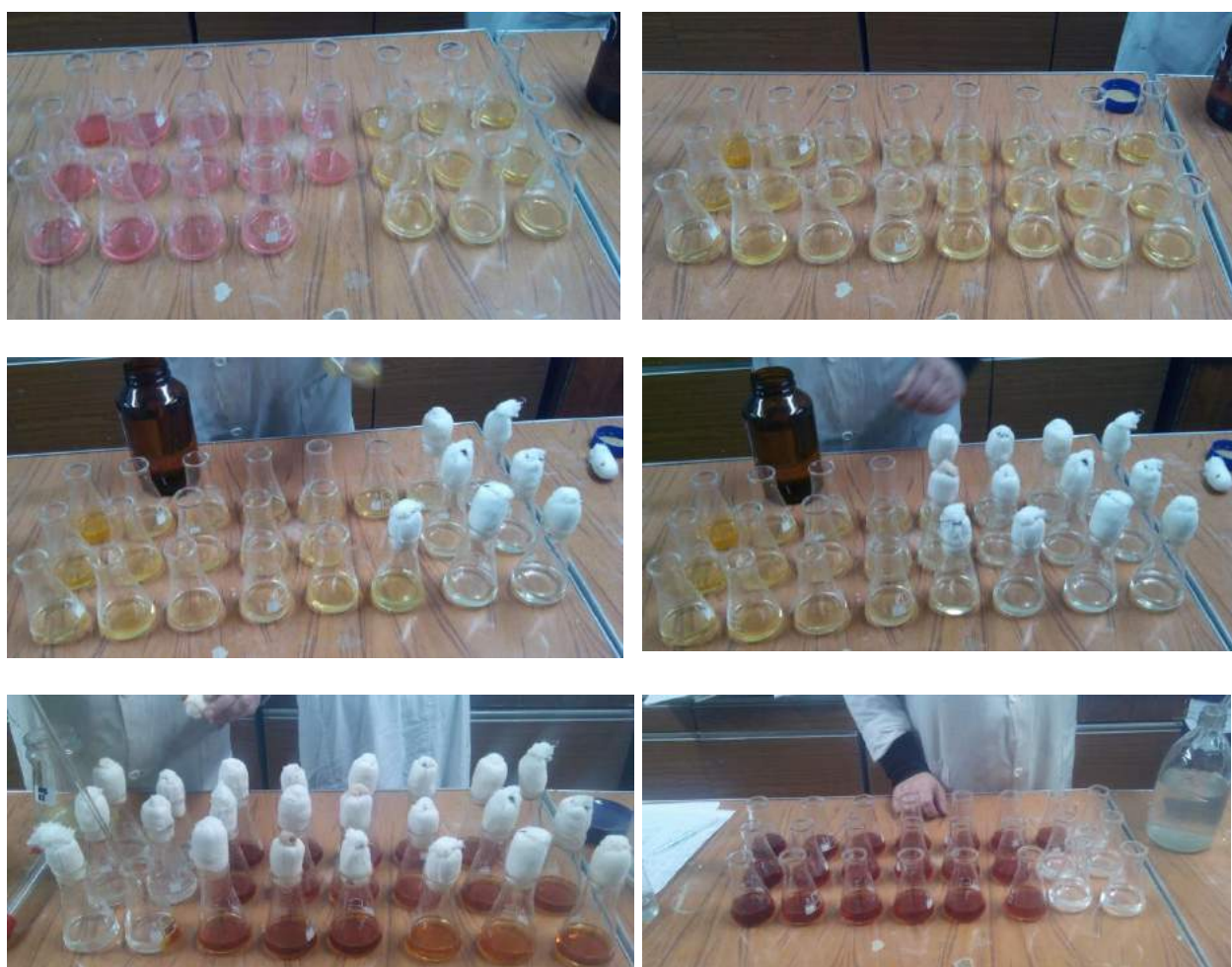
Рис. 5.5 – Процес проведення титрування при визначенні вмісту загального азоту
