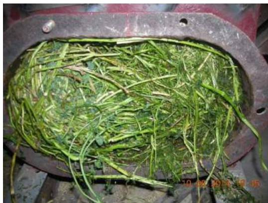
Рис. 3.39 – Процес структуризації рослинної сировини в просторі гвинтового ущільнювача з однобічним обертанням.
