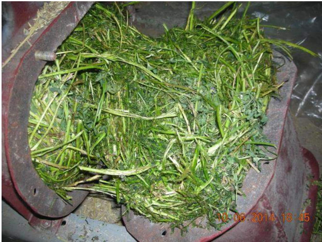
Рис. 3.44 - Ущільнення рослинної сировини в двогвинтовому ущільнювачі
