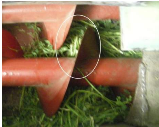
Рис. 3.39 – Процес структуризації рослинної сировини в просторі гвинтового ущільнювача з однобічним обертанням.
