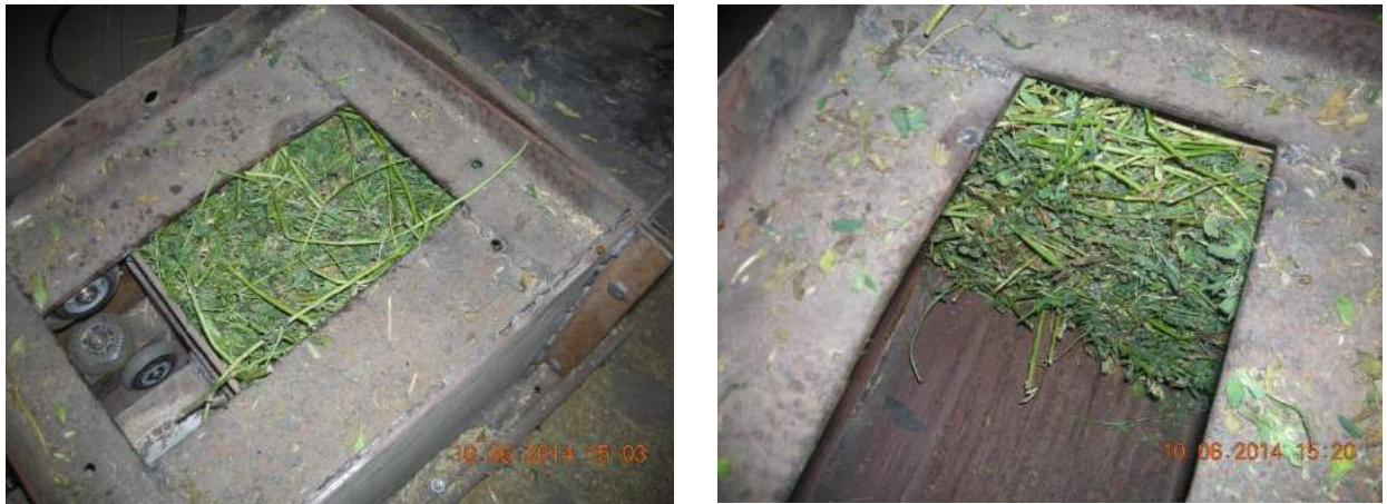
Рис. 3.37 – Вигляд рослинної сировини після попереднього ущільнення (хаотичне розміщення частинок).
