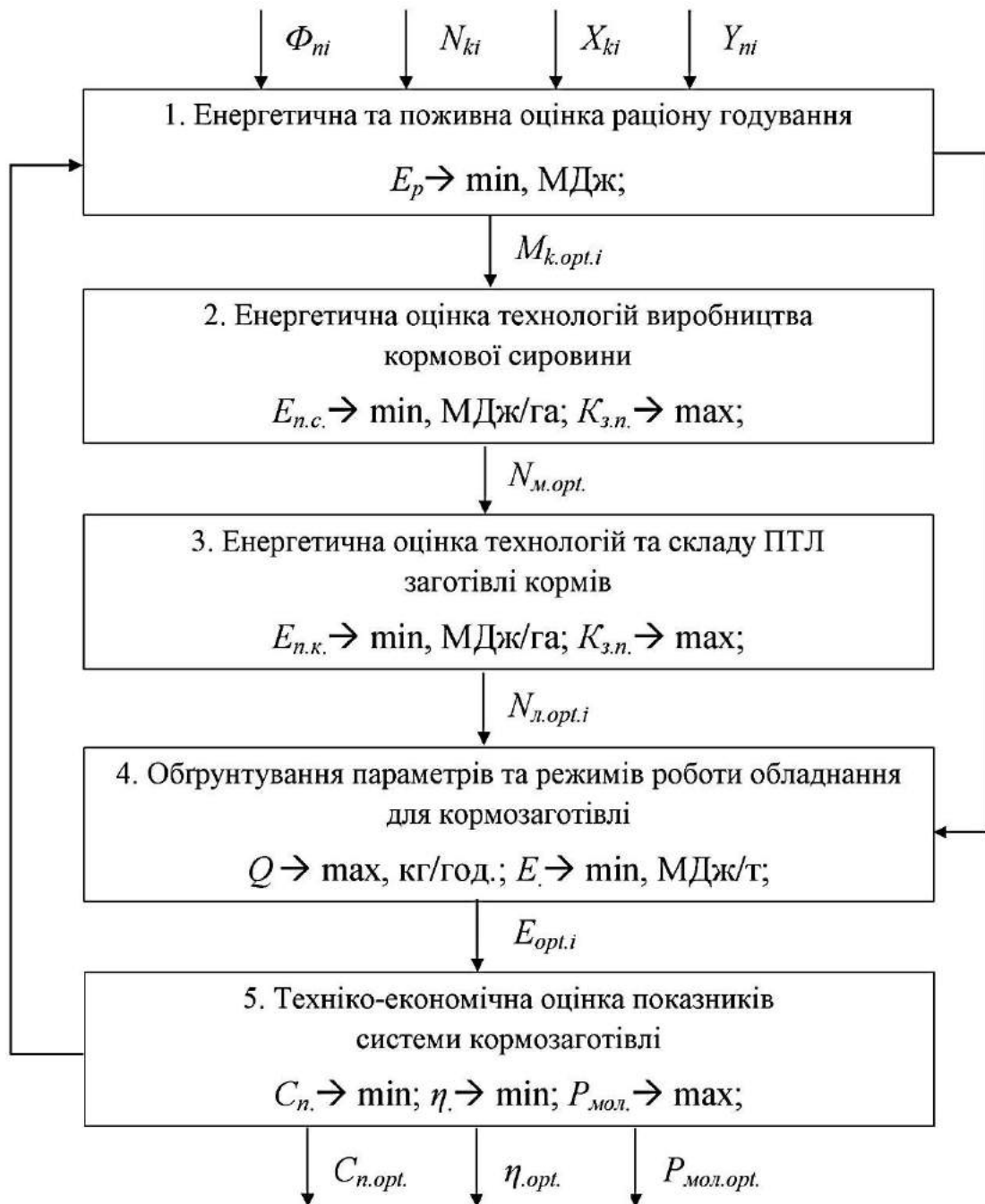
Рис. 2.1 – Алгоритм реалізації методологічних основ вдосконалення технічної системи кормозаготівлі
