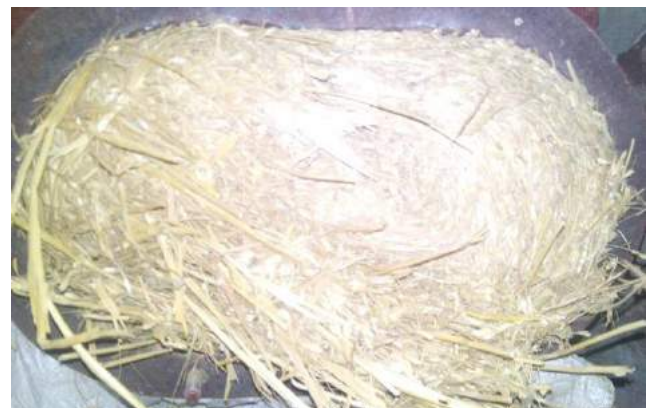
Рис. 3.39 – Процес структуризації рослинної сировини в просторі гвинтового ущільнювача з однобічним обертанням.
