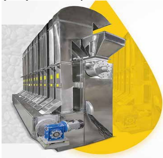
Рис. 1. Експериментальний зразок сортувальної машини для лушпиння соняшника
