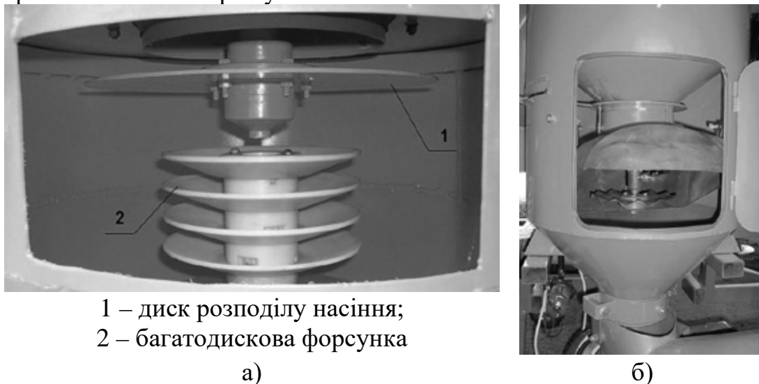
Рис. 3. Конструктивні особливості робочих камер протруювачів насіння: а) ПК-20; б) ПНК-15
