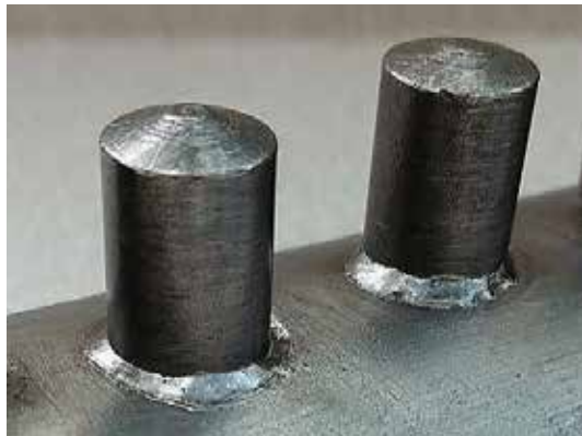
Рис. 1. Фрагменти приварених метизів (шипів), отримані при використанні розробленого обладнання і технології, сталі вказані за схемою «метиз - основа»: а) – Сталь 20 - 15X5М; б) – 12X1МФ - 15X5М; в) – Сталь 20 - 08X18Н10Т; г) – Аisi 304 - 12X17
